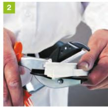
Ablängen der Einfassprofile 3736 auf die in Schritt 1 ermittelten Maße mit Hilfe der GIMA Multischere Art.-Nr. 7120-215.
