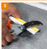
Gegengleiches Ablängen eines weiteren ADL-Profiles 3726 im 45°-Winkel mit der GIMA Multischere.
