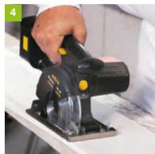
Der Zuschnitt der primusLPS-Laibungsplatten erfolgt mit der Akku-Handkreissäge Art.-Nr. 3502-100 oder anderen geeigneten Werkzeugen.
